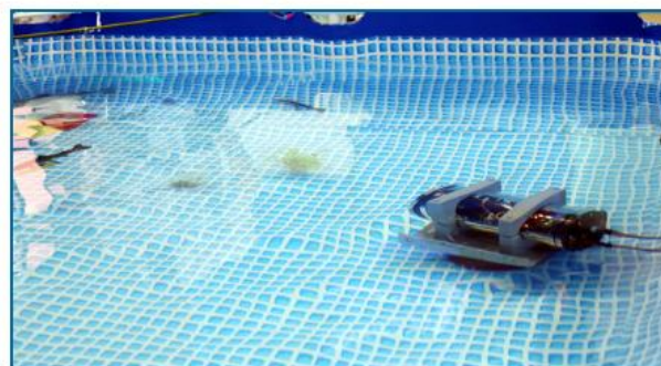
トリマティスの水中フュージョンセンサーで水中の物体を計測、撮影している様子。右側には魚の模型が動いている【クリックで拡大】
